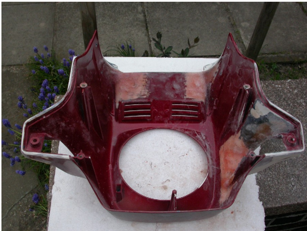
Bild 5: Verkleidung auf der nicht sichtbaren Seite (von innen) laminiert, alte Farbe vorher bis auf das Grundmaterial abgeschliffen
