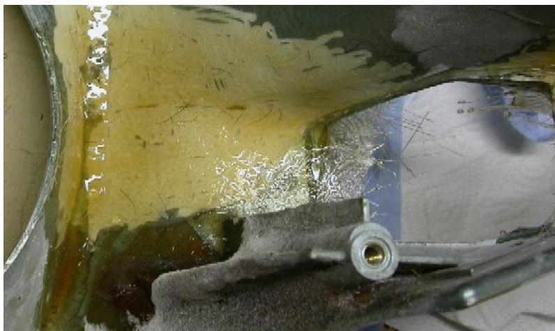
Bild 4: Blinkerohr innen laminiert (Grundmaterial freigeschliffen)
