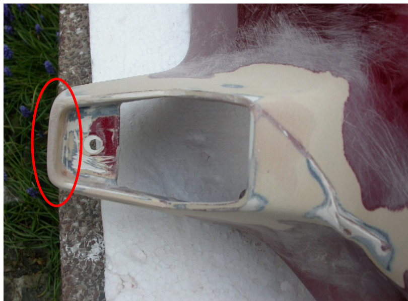
Bild 3: Blinkerohr nach dem Laminieren und Beschleifen, Außenbereich aus neuem Material aufgebaut, provisorische Form aus Blechstück innen, da Beschleifen außen leichter
