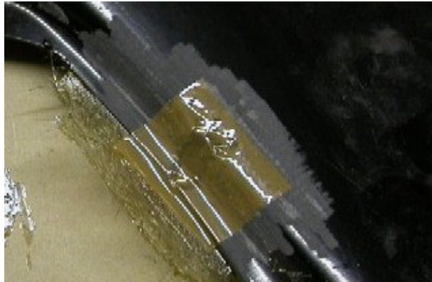
Bild 2: Klebeband verhindert Durchtropfen
